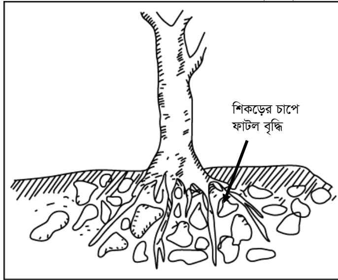
চিত্র-৩.৩০: শিকড়ের চাপে বিচূর্ণীভবন
